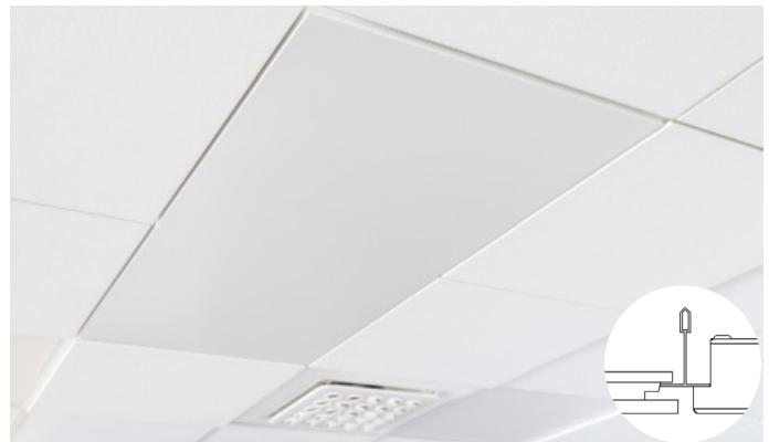
ItuGraf®-modell Dg er designet for å passe med Dg-kanten i Focus-utvalget. Dg-kantdesignet har skjulte støttekanter for å skape et karakteristisk flytende utseende. Opphengsrutenettet er ca. 14 mm over den synlige overflaten til flisen, som gir inntrykk av at hver flis er hengt opp individuelt. Alle flisene kan enkelt demonteres.
