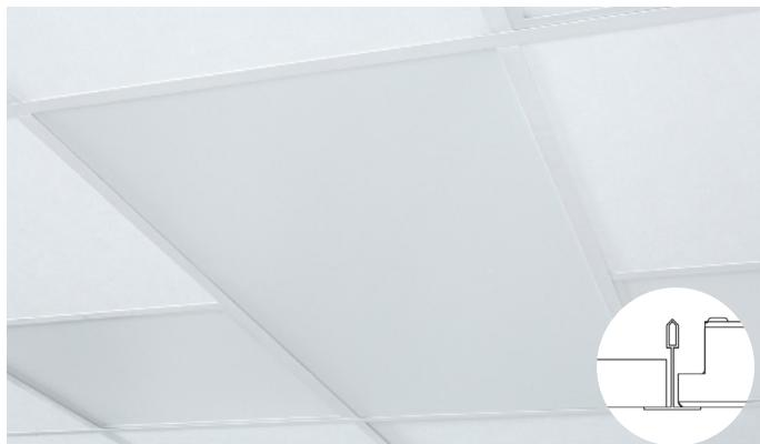
ItuGraf®-modell A integreres med A-kanten i Focus- og Master-taksystemene. A-kanten har et synlig rutenett og fliser som enkelt kan demonteres. Til forskjell fra de andre kantene, kan ItuGraf®-modell A-taket brukes med T24-rutenettet og også med T15-rutenettet.
