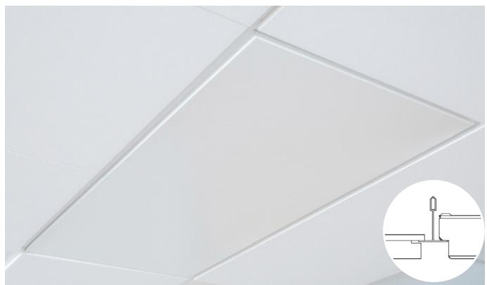
ItuGraf®-modell Ds kan brukes med Ds-kanten i Focus- og Master-utvalget. Ds-kanten er egnet for bruksområder der et nedhengt tak med et skjult rutenett kreves. Flisene har et symmetrisk kantdesign. Taket har et jevnt utseende, der de avskrådde kantene danner en diskret rille mellom flisene. Flisene kan enkelt demonteres.
