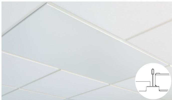
ItuGraf®-modell E er designet for å passe med E-kanten i Focus- og Master-serien. E-kanten har et forsenket synlig rutenett, noe som skaper et tak med en skyggeeffekt. Den synlige overflaten for hver flis er 10 mm under rutenettet. Alle flisene kan enkelt demonteres.
