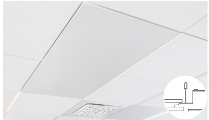
ItuGraf®-modell M er designet for å passe med M-kanten. M-kantdesignet har skjulte støttekanter for å skape et karakteristisk flytende utseende. Opphengsrutenettet er ca. 14 mm over den synlige overflaten til flisen, som gir inntrykk av at hver flis er hengt opp individuelt. Alle flisene kan enkelt demonteres.
