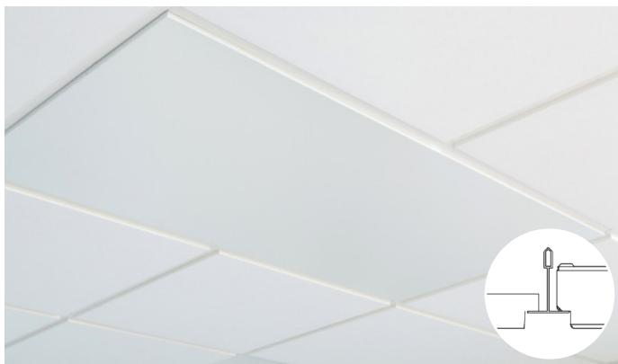
ItuGraf®-modell X kan brukes med X-kanten. X-kanten er egnet for bruksområder der det er nødvendig med nedhengt tak med et skjult rutenett. Flisene har et symmetrisk kantdesign. Taket har et jevnt utseende, der de avskrådde kantene danner en diskré rille mellom flisene. Flisene kan enkelt demonteres.
